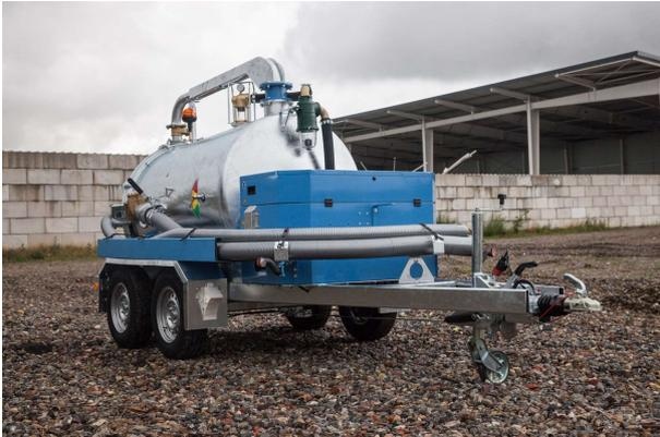
Der 360° frei drehbare Ausleger des Saugschlauches bietet eine einzigartig handliche Anwendung und stellt einen schnellen und sicheren Arbeitsprozess sicher.
